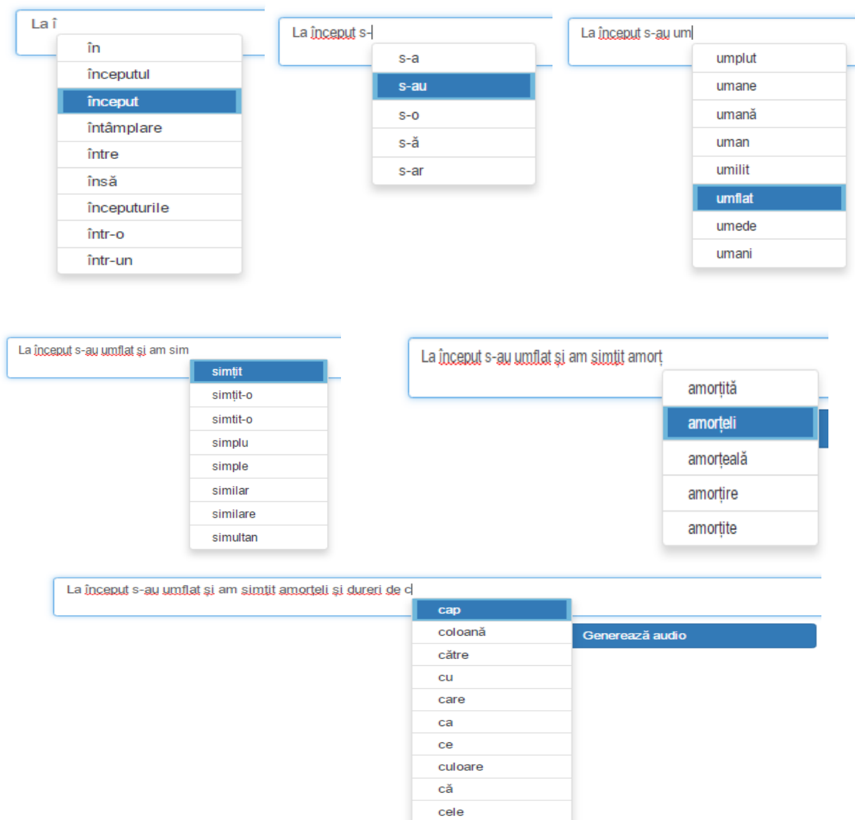
Figura 3.5.9. Scenariu de predicție text integrat în sistemul de sinteză (Atenție: predicția e realizată doar la nivelul unui singur cuvânt !).
